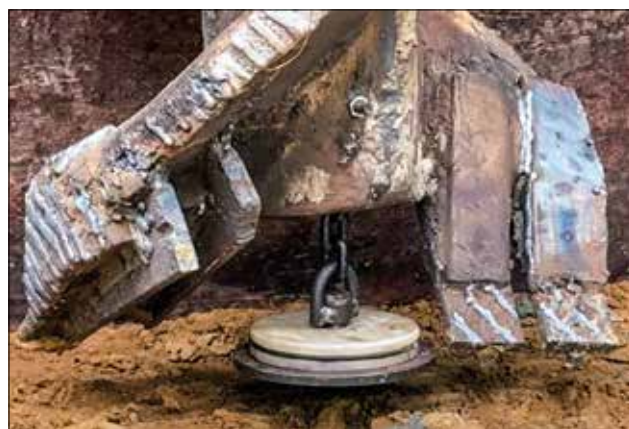
FIGURA 4 EXTREMIDADE INFERIOR DO TRADO DA HÉLICE CONTÍNUA
