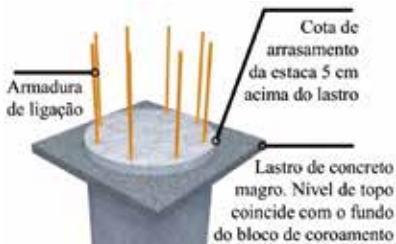
FIGURA 6 ESTACA ARRASADA COM CONCRETO MAGRO FONTE: NAKAJIMA E MARTINS (2022)
