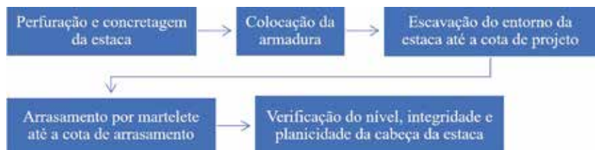
FIGURA 8 PROCEDIMENTOS EXECUTIVOS DE ARRASAMENTO POR MARTELETE
